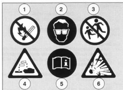
Предупреждающая наклейка на батарее
