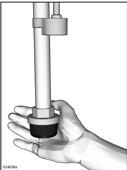
7. Заполните гайку щелевого уплотнения жидкостью TSL, чтобы предотвратить преждевременный износ уплотнителя. Проделывайте эту операцию ежедневно или при каждом распылении.
