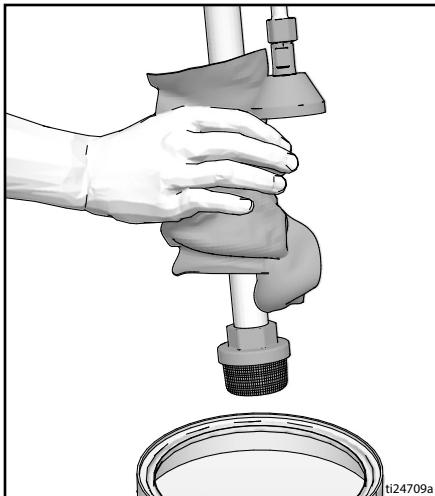
4. Поместите патрубок забора жидкости в емкость с промывочной жидкостью. Для красок на водной основе используйте воду, для красок на масляной основе – уайт-спирит. Поместите сливную трубку в емкость для отходов.
