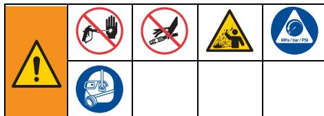
Это оборудование будет оставаться под давлением до тех пор, пока давление не будет снято вручную. Во избежание получения серьезной травмы, вызванной жидкостью под давлением (например, в результате прокола кожи, разбрызгивания жидкости и контакта с движущимися деталями), выполняйте процедуру снятия давления после каждого завершения распыления и перед очисткой, проверкой либо обслуживанием оборудования.
