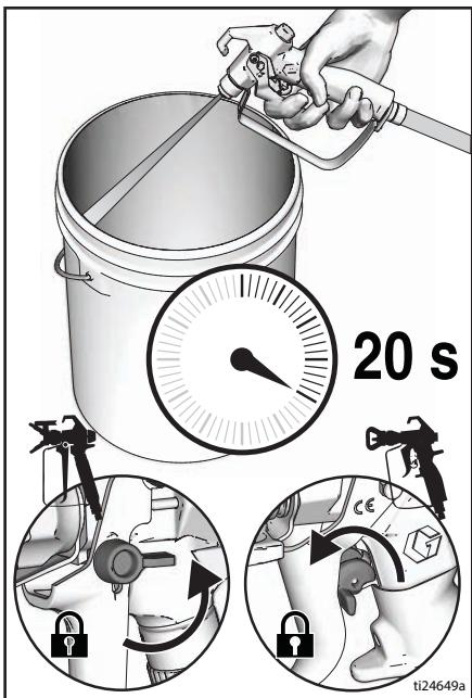
12. Поверните ручку регулятора давления в положение минимального значения и переведите переключатель ON/OFF (ВКЛ/ВыКЛ) в положение OFF (ВыКЛ). Отсоедините источник питания от распылителя.
