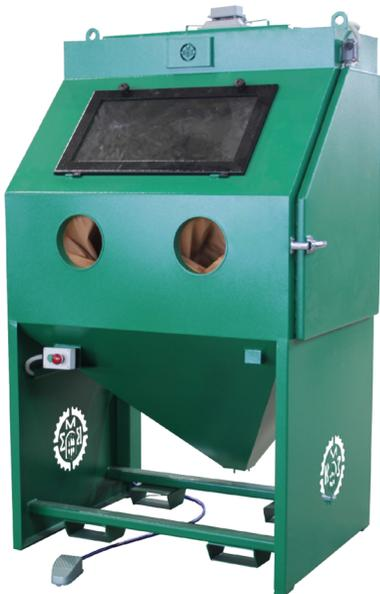
Камера струйная «КСО® – 110» с инжекторным способом формирования воздушно-абразивной смеси предназначена для снятия ржавчины, песка и окалины, получения необходимой шероховатости, снятия слоёв, матирования, упрочнения, снятия заусенцев и полирования, а так же для подготовки поверхностей перед нанесением антикоррозионных покрытий (лакокрасочных материалов, металлизационных покрытий).
