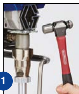
1 Ослабить зажимную гайку
